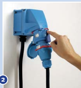
2 Ein einfacher Knopfdruck auf den Auslösehaken unterbricht den Stromkreis, der Stecker springt in seine Ruhestellung und wird im Bajonett gehalten.
