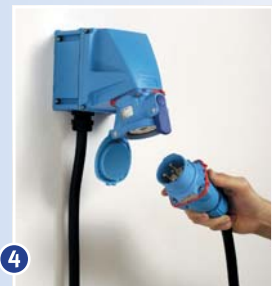
4 Stecker und Dose sind jetzt getrennt, unbeabsichtigte Zugriffe auf spannungsführende Teile werden entweder durch eine Drehsicherheits-scheibe (DS, DSN) oder durch Schutzart IP4X (DB) bzw. IP2X (DN) verhindert.
