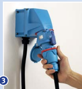
3 Der Stecker kann nun in aller Sicherheit herausgenommen werden, indem man ihn einfach um eine Vierteldrehung nach links (DS, DSN, DB-Baureihe) bzw. nach rechts (DN-Baureihe) dreht.
