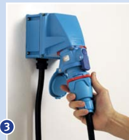
3 Ștecherul poate fi extras acum în condiții de siguranță deplină; pentru aceasta rotiți-l cu un sfert de rotație spre stânga (modelul DS, DSN, DB), resp. spre dreapta (modelul DN).
